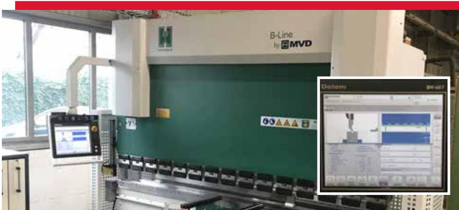
Die neue Biegepresse ermglicht eine digitale Steuerung und die Erstellung eigener Programme via Touchscreen (kleines Bild).
